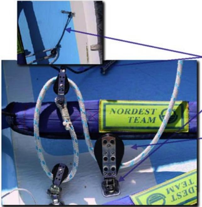
Am freien Block ist der **Verlängerungstampen** eingebunden (zur Affenschaukel). Seine Länge wird dreifach an Schotlänge eingespart (wegen der dreifachen Übersetzung).
