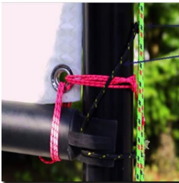
Die richtige Höhe des Baums am Mast wird mit einem Bändsel justiert, das von der Baumgabel über einen **Zapfen am Mast** wieder zurück zur Baumgabel verläuft und vor dem Mast verknotet werden kann.
