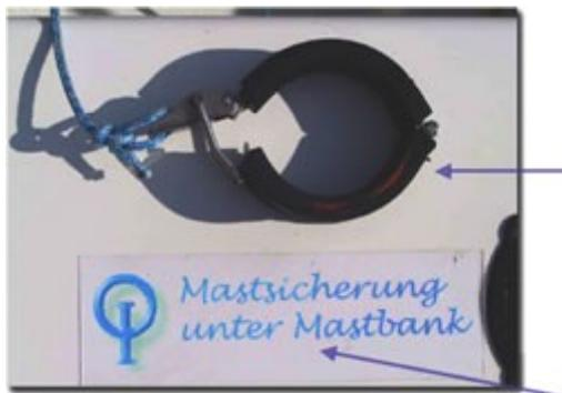
Der Mast muss gesichert werden. Im Falle einer Kenterung könnte andernfalls der Mast aus dem Mastschuh rutschen und bei Welle oder spätestens beim Aufrichten des Opti durch seine große Hebelwirkung die Mastbank zerstören:
