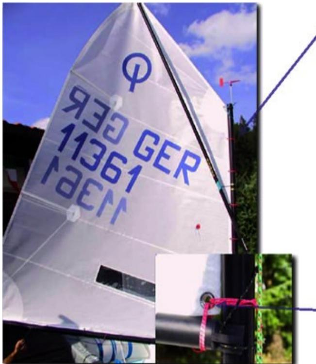
Das Opti-Segel wird an seinem Vorliek mit **Bändseln am Mast** und an seinem Unterliek entsprechend am Baum befestigt. Dazu sind am Vorliek und am Unterliek Kauschen (Ösen) vorhanden.
